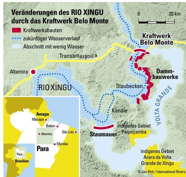
Die geplante Leistung kann durch die unbeständige Wasserführung des Xingu nur 3–4 Monate geliefert werden. Es wird befürchtet, dass weitere Staudämme gebaut werden, um die Wirtschaftlichkeit sicherzustellen. Zudem wird nahe der „Volta Grande“ Goldabbau geplant.
